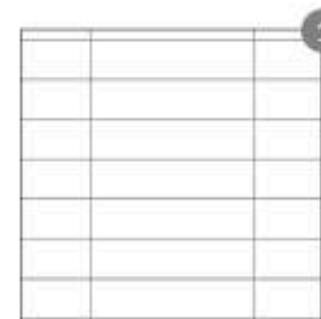
Traditional rectangular format laying in horizontal. Colocación tradicional formato rectangular en horizontal.
